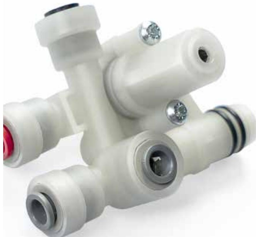
El módulo de salida patentado gestiona automáticamente el rechazo, variando, según las condiciones del agua de entrada, la cantidad de agua desechada. El sistema SMART DRAIN gestiona el nivel correcto entre permeado y rechazo, ayudando así a que la membrana dure más tiempo y permitiendo que el equipo trabaje a presión constante. Gracias a esta innovación, la máquina trabaja mejor y requiere menos asistencia técnica.
